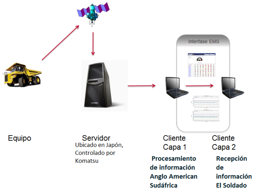
Figura 1.2-1: Sistema Actual de Monitoreo de Signos Vitales de Equipos Komatsu.
