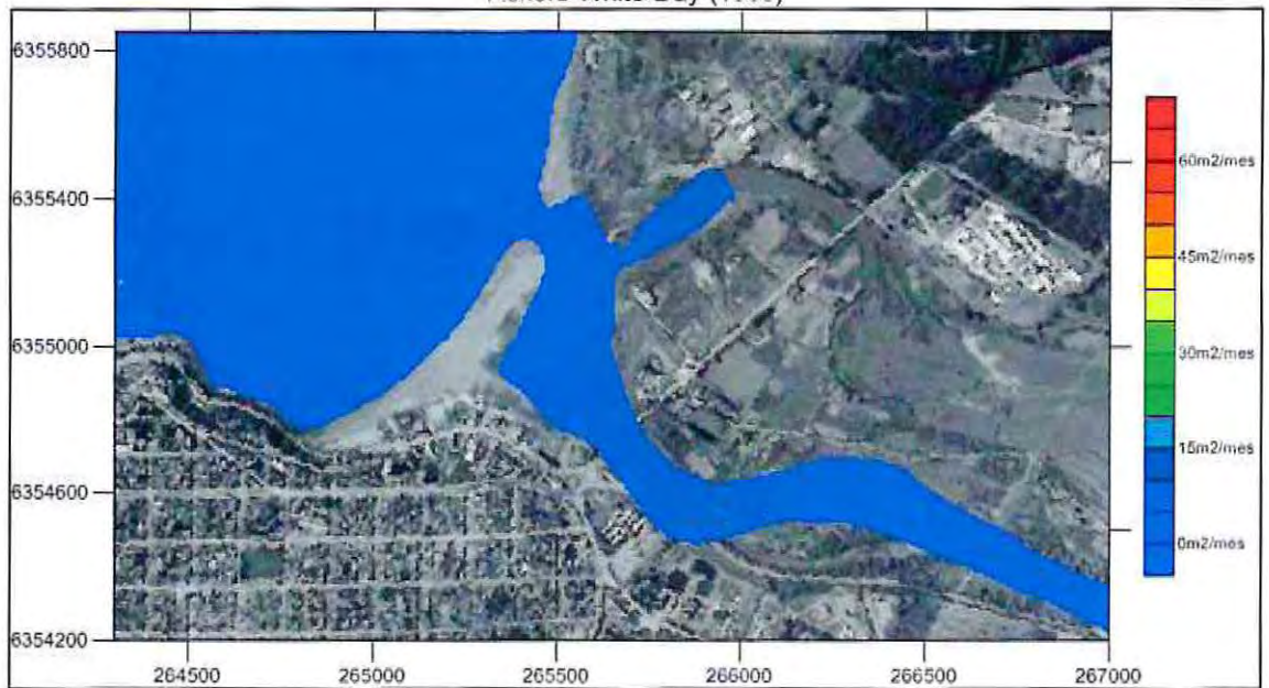
Figura 5.3-18: Transporte de sedimento en un ciclo de marea de Sicigia para el caudal máximo de Octubre según Ackers-White-Day (1983)
