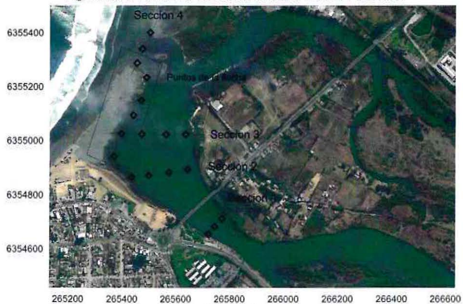
Figura 4.3-4: Puntos de extracción de datos modelo FESWMS.
