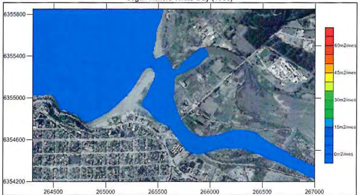
Figura 5.3-11: Transporte de sedimento en un ciclo de marea de Cuadratura para el caudal máximo de Junio según Ackers-White-Day (1983)
