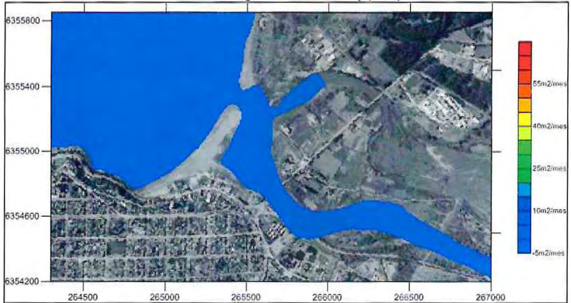
Figura 5.3-20: Transporte de sedimento en un ciclo de marea de Cuadratura para el caudal máximo de Noviembre según Ackers-White-Day (1983)
