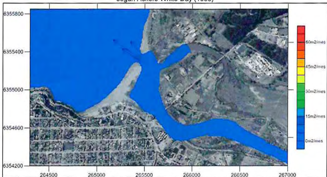
Figura 5.3-15: Transporte de sedimento en un ciclo de marea de Cuadratura para el caudal máximo de Agosto según Ackers-White-Day (1983)
