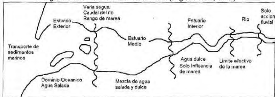
Figura 3.1-1: Elementos de un estuario (según Perillo, 1995)
