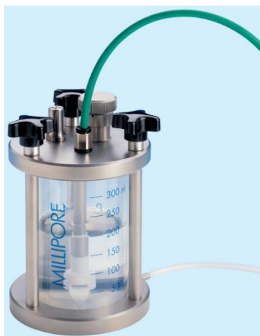
Figura 24. Sistema de Ultrafiltración (célula con agitación Amicon®) modificado.
