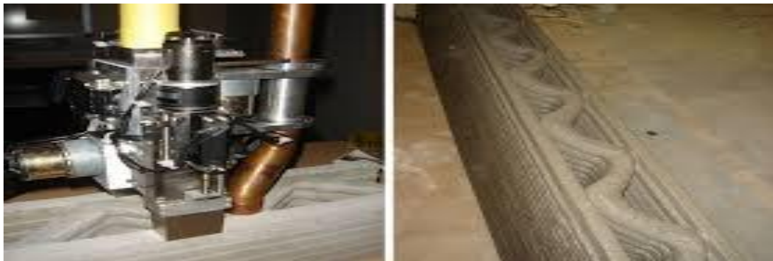
Figura 2.14: Impresora realizando rellenos interiores, tomado de http://cort.as/-M5Ps , 2018
