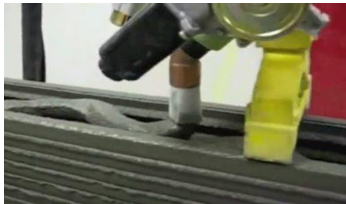
Figura 2.9: boquilla extrusora con paleta de terminación lisa tomado de Azukotech.com, 2020
