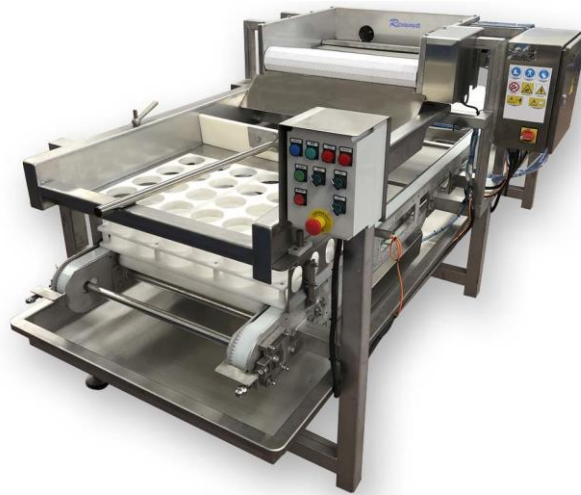
Figura 4 Equipo de dosificación de granos de queso a moldes. Fuente: Remma, 2024
