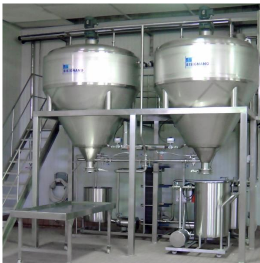
Figura 9 Silos de suero para producción de ricota. Fuente: GoldPack, 2024
