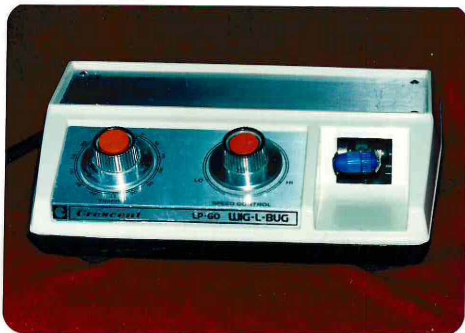
Fotografía No. 11.- TRITURADOR CRESCENT LP - 60.
