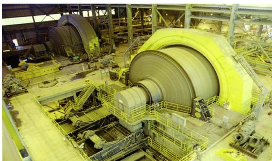
Figura 9. Molino SAG (Molienda Semi-Autógena)
