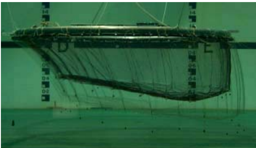
Figura 27. Afeción en la estructura de una red lobera debido corrientes marinas simuladas. Fuente: Marine and Marine Industries Council, Tasmania 2002.
