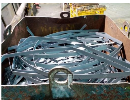
Figura 5.10 Contenedor con despunte de zunchos metálicos en Productos metalúrgicos (Elaboración propia, 2022).
