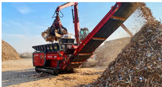
Figura 5.25 Trituradora de madera alimentada por grúa hidráulica de garra. (Hammel, 2022)
