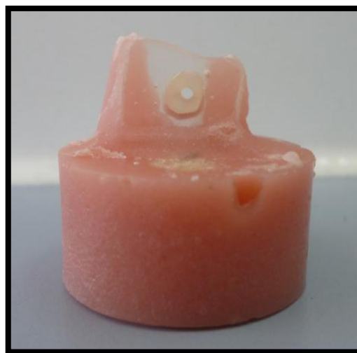
Figura 37. Muestra con el poste desalojado.
