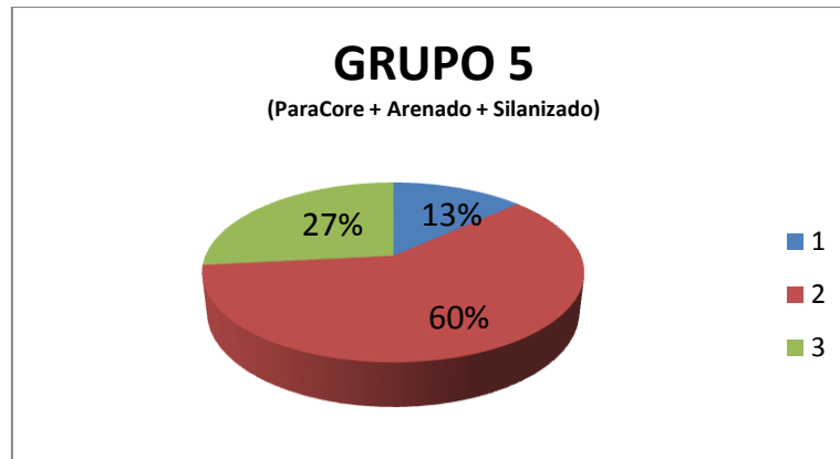
Figura 9. Porcentajes de tipo de falla adhesiva diente-cemento (1), poste-cemento (2) y mixta (3).
