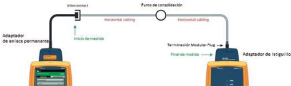
Figura 6. Certificación Cableado Híbrido Direct Link mediante plataforma VERSIV.
