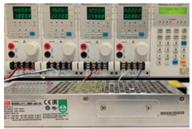
Figura 3. Prueba de voltaje de la UMP-400-48KJ.
