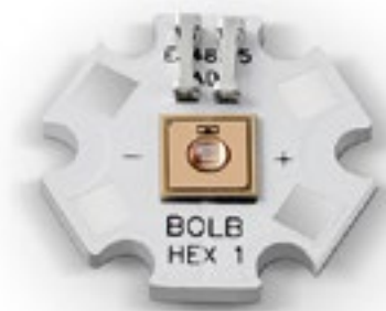
Figura 2. Led UVC de elevada salida - alta potencia de Bolb con 100 mW a 250 mA, con y sin montura. Fuente: Bolb
