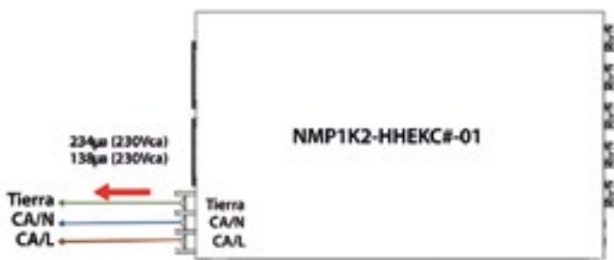
Figura 1. Corriente de fuga de 138µA por debajo de 120Vca. Corriente de fuga de 234µA por debajo de 230Vca.
