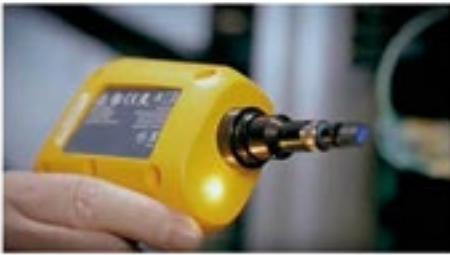
Figura 3. Inspección de conectores de fibra MPO.
