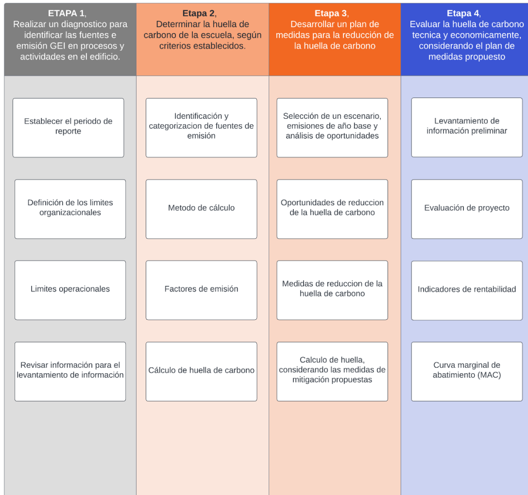
Figura N°4.1: Diagrama del desarrollo de proyecto y el cálculo de Huella de Carbono para el edificio de la Escuela de Ingeniería Ambiental.
