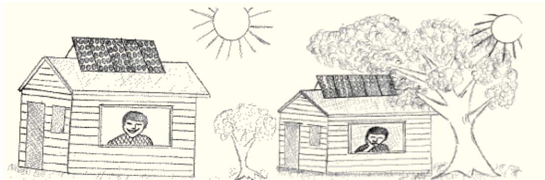
Figura 9.4 - La sombra de arboles u otros objetos sobre el panel fotovoltaico afecta el funcionamiento de todo el sistema
