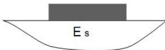
Figura 3.2 Losa sobre fundación Sólido Elástico
