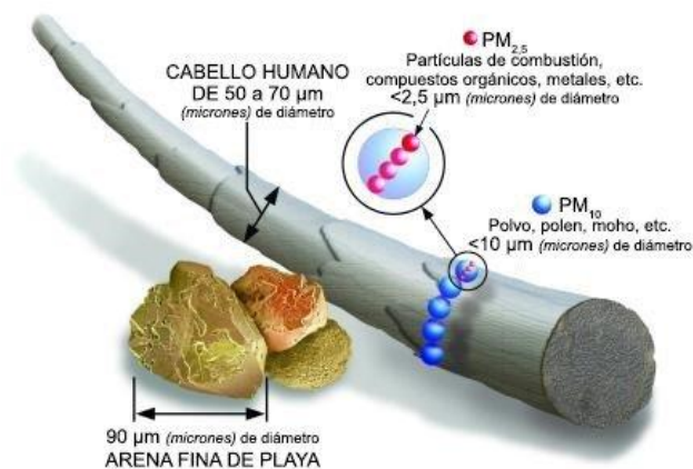
Figura 1.2: Ejemplificación del tamaño del PM10 y PM2.5 en comparación con un cabello humano.
