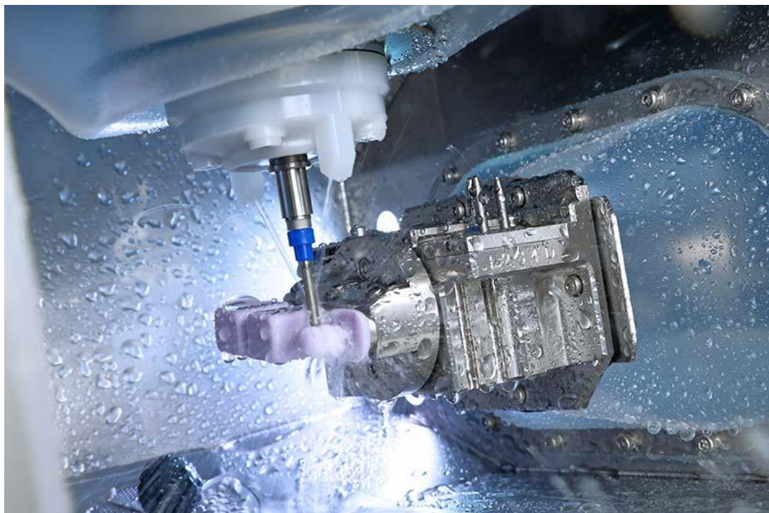
Figura 4: Fresadora asistida por computadora (CAM), técnica sustractiva
