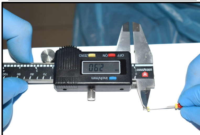
Figura N° 7 Ejemplo de medición mediante calibrador digital.
