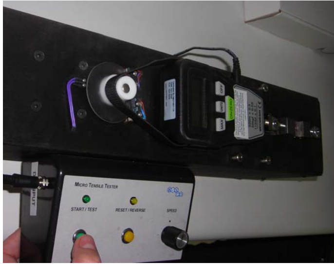
Foto n°19: Máquina de microtracción Instron.
