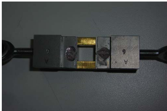
Foto n°18: Muestra ya testeada en máquina de Microtracción.
