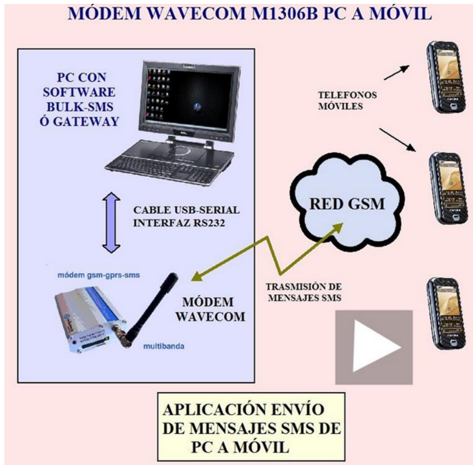
Figura 2. Esquema de una red GSM con la utilización de un módem anclado a una computadora, (PuntoFlotante S.A).
