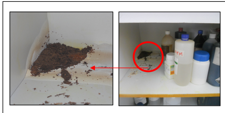
Figura N°7. Registro de derrames y corrosión interna de estanterías.
