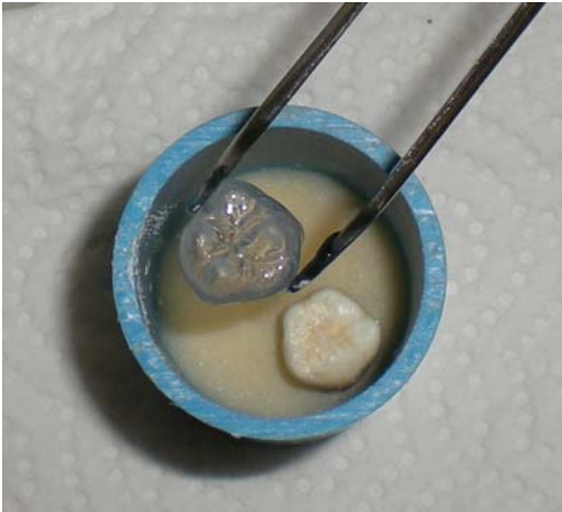
Figura 7. Cuerpo de prueba. Molar montado y cubetilla de poliacetato
