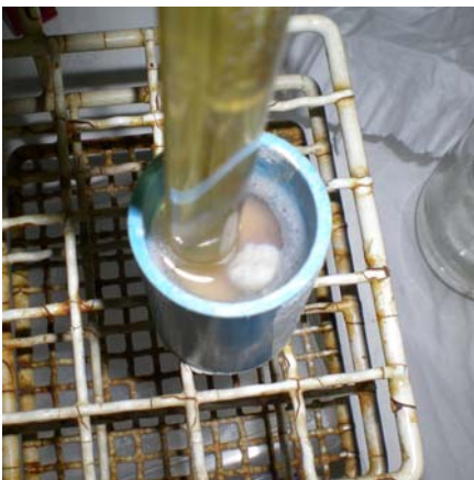
Figura 8. Medición pH salival. Punta del electrodo dentro del cuerpo de prueba
