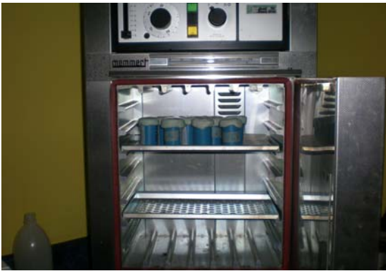
Figura 8. Muestras con tapa dentro del horno a 37°C
