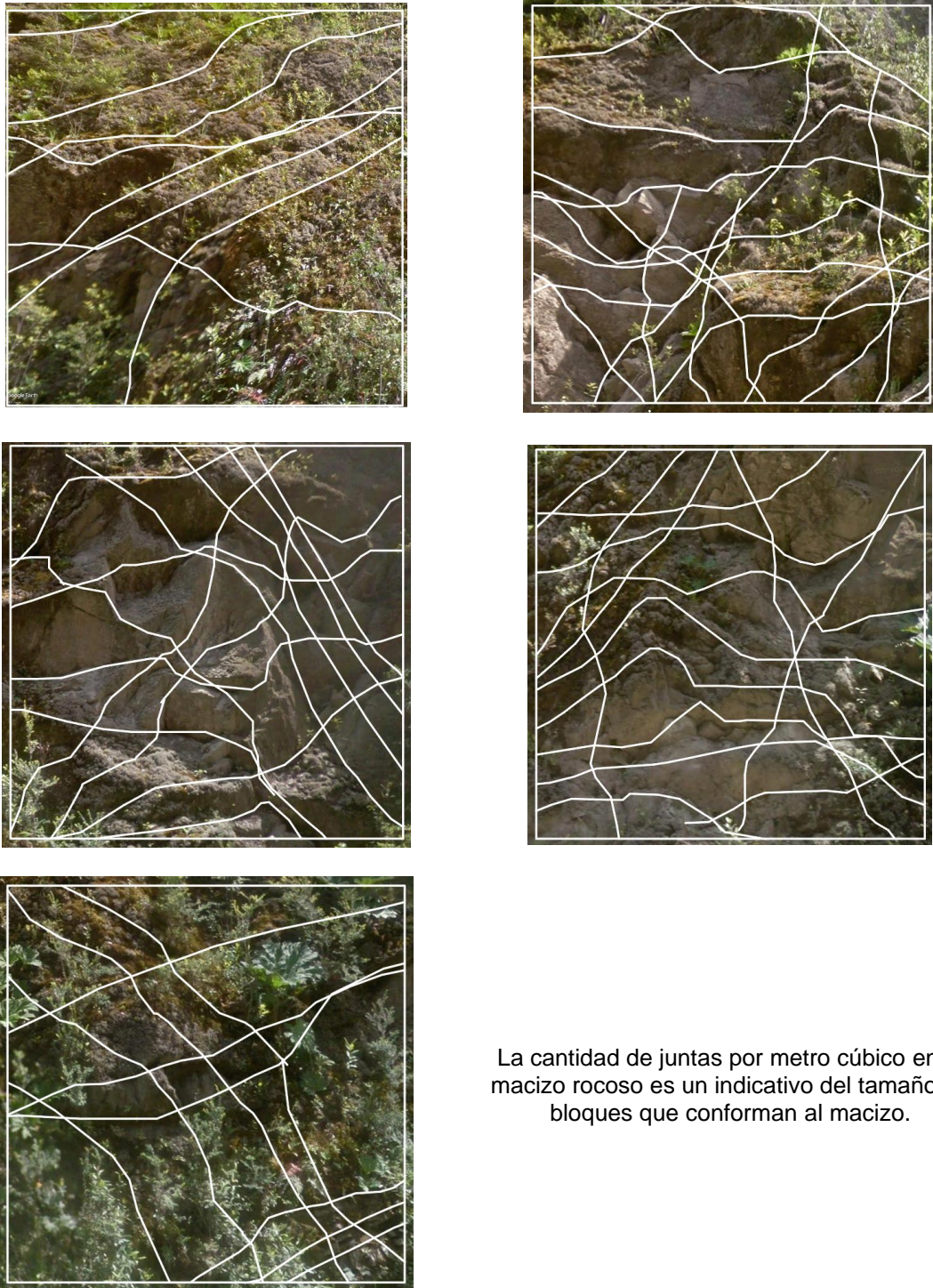
Figura 4.19 – Perfiles de principales discontinuidades en el Talud B – Fuente: Elab.propia.
