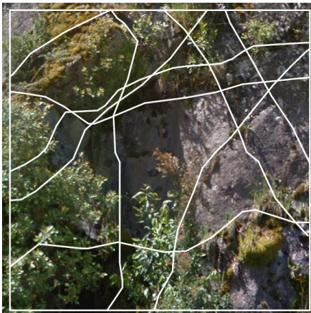
Figura 4.18 – Perfiles de principales discontinuidades en el Talud A – Elab.propia.
