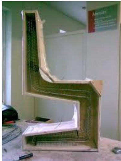
Imagen 38 ejemplo de un molde para un mobiliario de hormigón armado.
