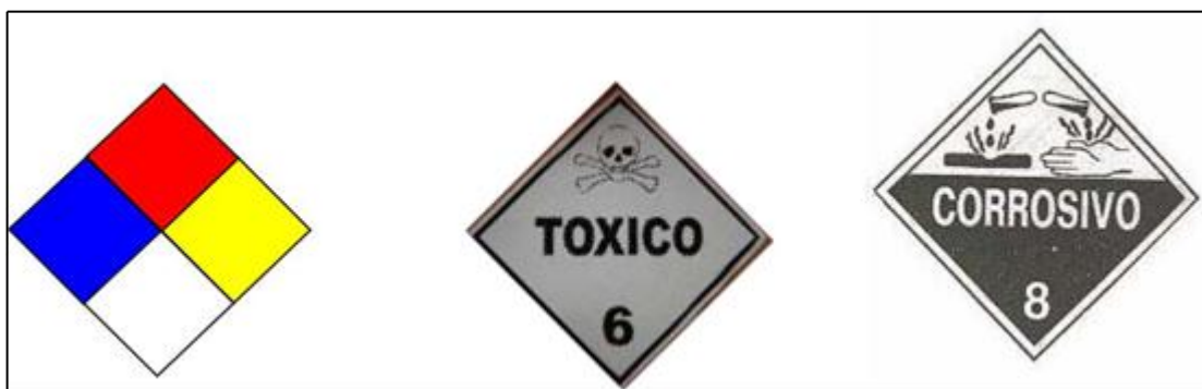
Figura 5.3a: a la izquierda según NFPA, que representa nivel de combustión 0, reactividad 2, Evitar contacto con agua y riesgo para la salud de 3. En los dos rombos restantes lo identifica como tóxico y como corrosivo con nivel 8.
