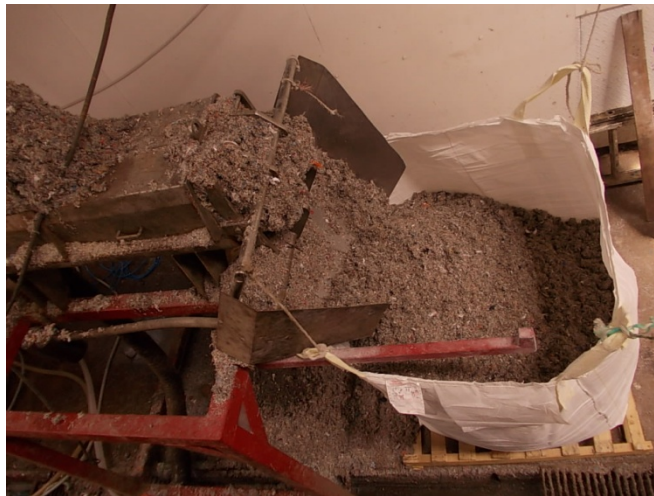
Figura 7: Batea de Lavado con acumulación de plumilla.
