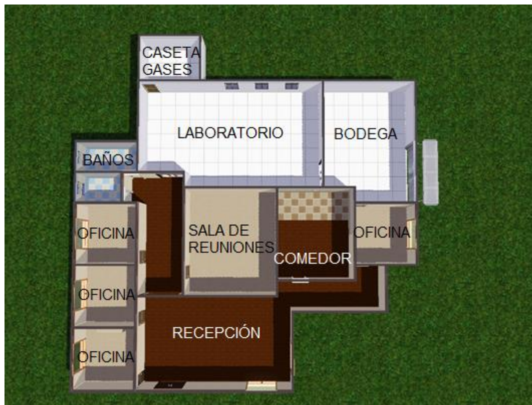
Figura 16: Diseño ejemplo de un laboratorio certificador de ventiladores y máquinas de anestesia (Elaboración propia).
