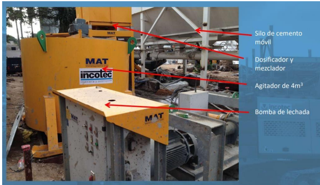
Ilustración 2.19 - Equipos en obra para ejecutar método SCM, fuente: https://incotecperu.pe/obras .
