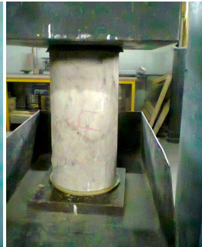
Figura 4.8: Falla probeta sometida a compresión.
