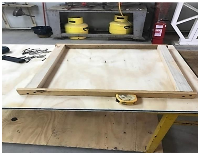
Ilustración 3.7: Moldes de probetas a ensayar.
