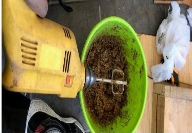
Ilustración 3.4: Mezcla de los componentes del aislante. Fuente: Elaboración propia.
