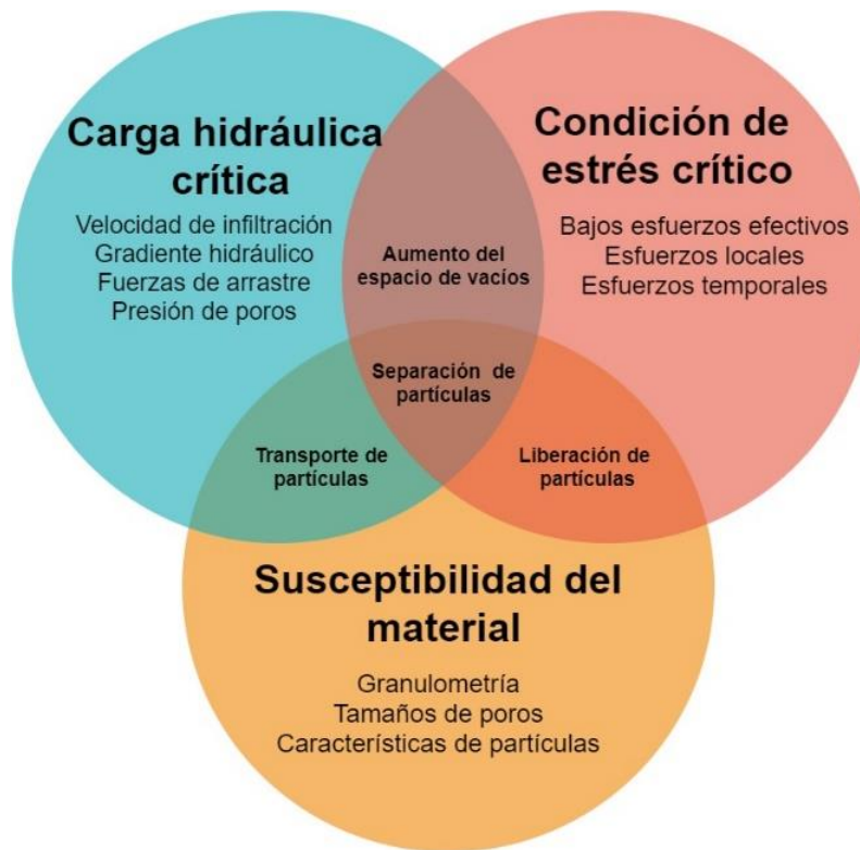
Figura 2.15. Diagrama de Venn ilustrando la interacción de las diferentes características del medio para iniciar la erosión interna. Fuente: Garner y Fannin (2010) [43], elaboración propia.
