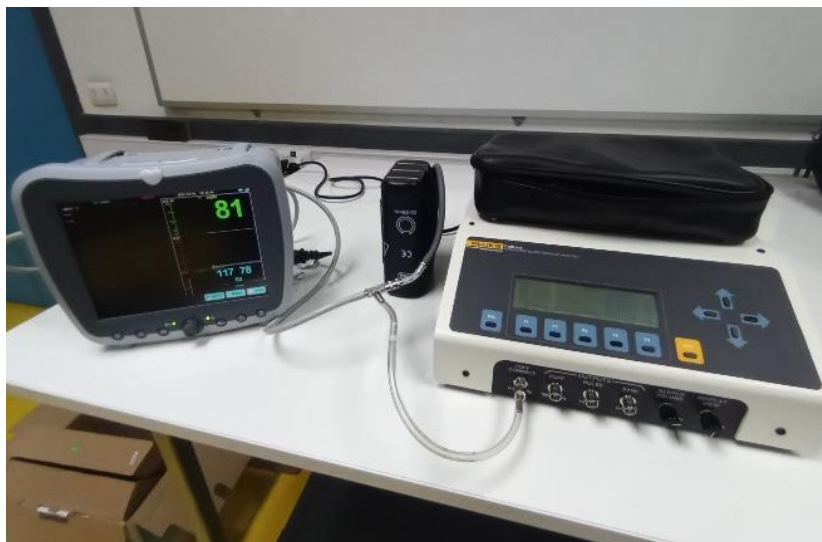
Fig. 3: Dispositivo Meditech conectado al analizador CuffLink Fluke
