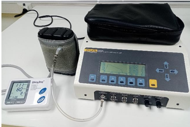
Fig. 2: Dispositivo Bokang conectado al analizador CuffLink FLUKE.
