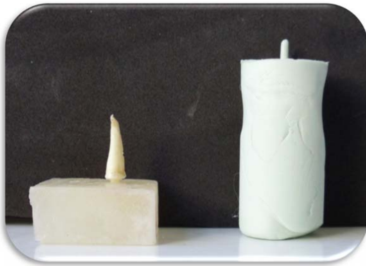
Figura 34. Dispositivo de acrílico y silicona utilizados para estandarizar los postes.
