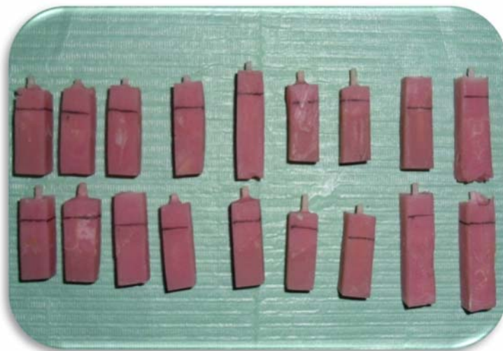
Figura 35. Cubos de acrílicos con los dientes en su interior.
