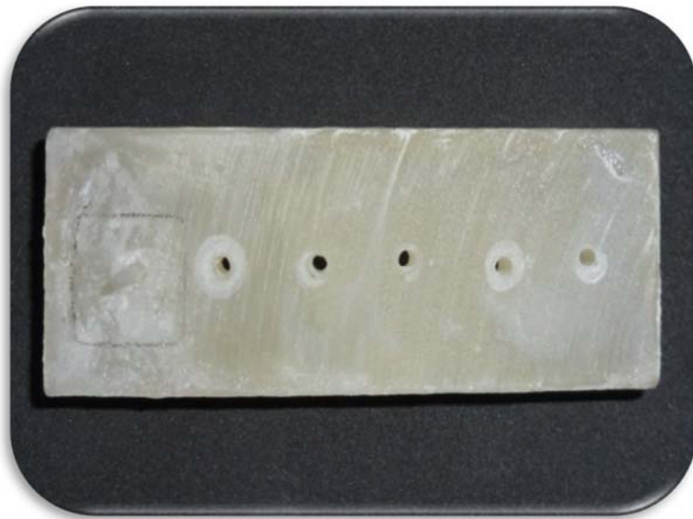
Figura 32. Dispositivo de acrílico para sujeción del poste.
