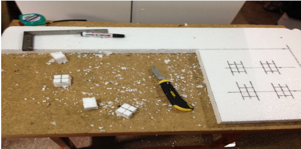
Figura 3.2 Trazado y corte de planchas de poliestireno expandido. Fuente: Elaboración Propia, 2016.
