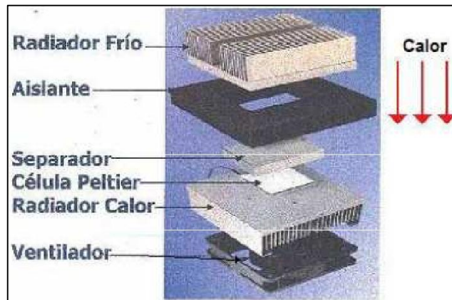
Figura 2.6 Montaje de un módulo Peltier (Serrano, 2010)
