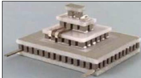
Figura 2.7 Módulos termoeléctricos superpuestos (Serrano, 2010)
