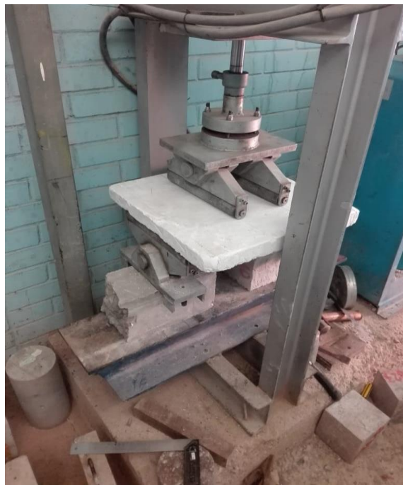
Figura 3.8: Vista frontal. Máquina de prueba universal aplicando carga sobre panel.
