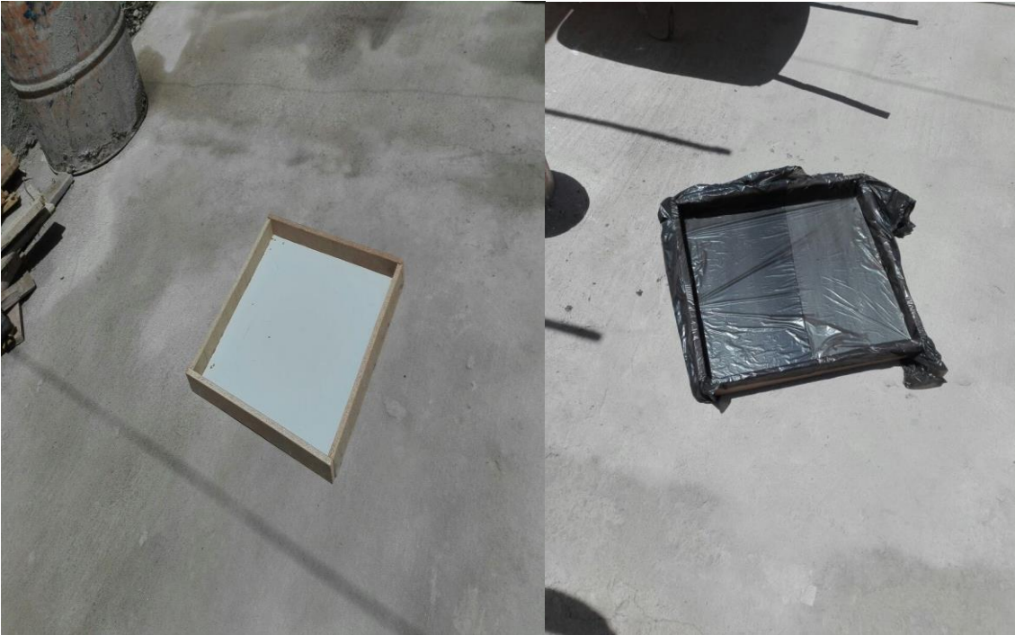
Figura 3.1: Molde utilizado para la confección de paneles, en bruto y forrado.
