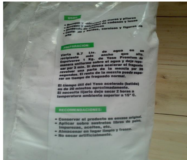
Figura 3.2: Indicaciones del fabricante para la elaboración de la pasta de yeso.
