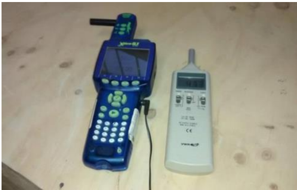
Figura 3.13.- Xplorer GLX con sensor de sonido y sonómetro.
