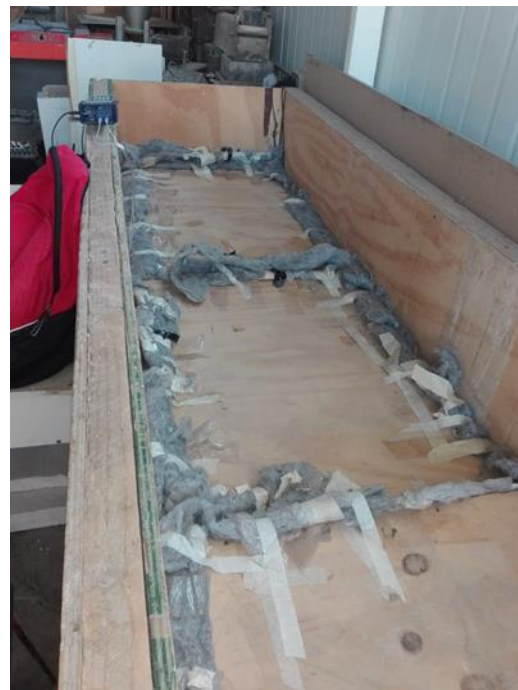
Figura 3.12 Cámara térmica sellada
