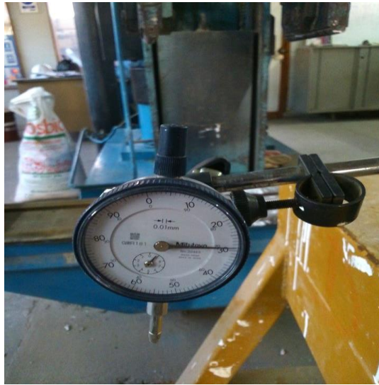
Figura 3.9: Micrómetro con dial utilizado para medir la deformación.
