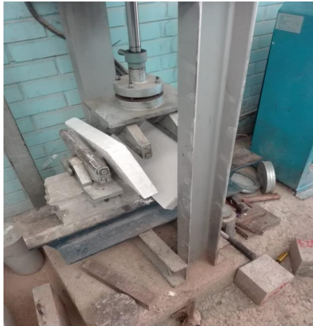
Figura 3.7: Máquina de prueba universal utilizada para ensayo de Flexión.
