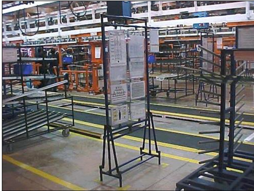
Ilustración 42: Ejemplo de rack con manual estandarizado.
