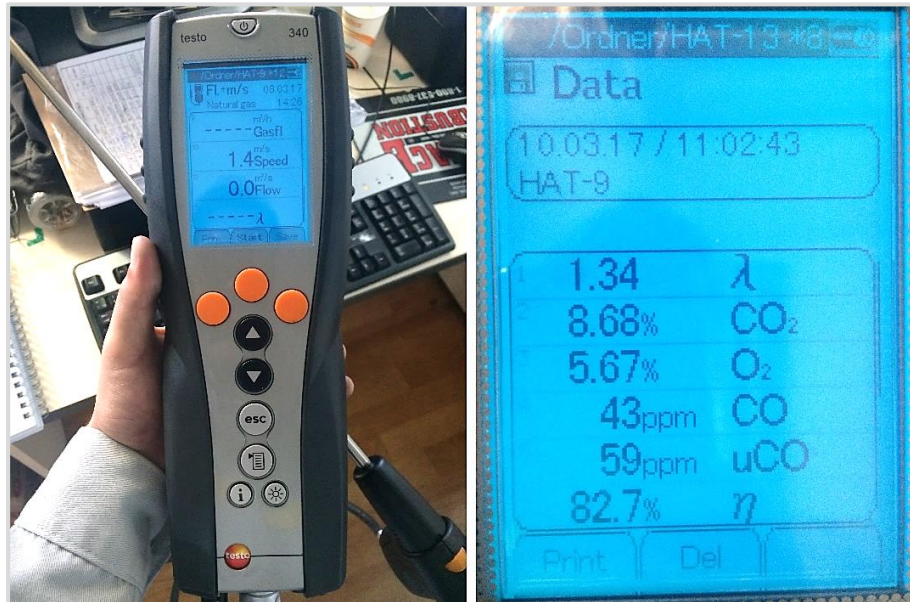
Figura 53 - Instrumento utilizado para la medir temperatura, rendimiento y exceso de aire en gases.
