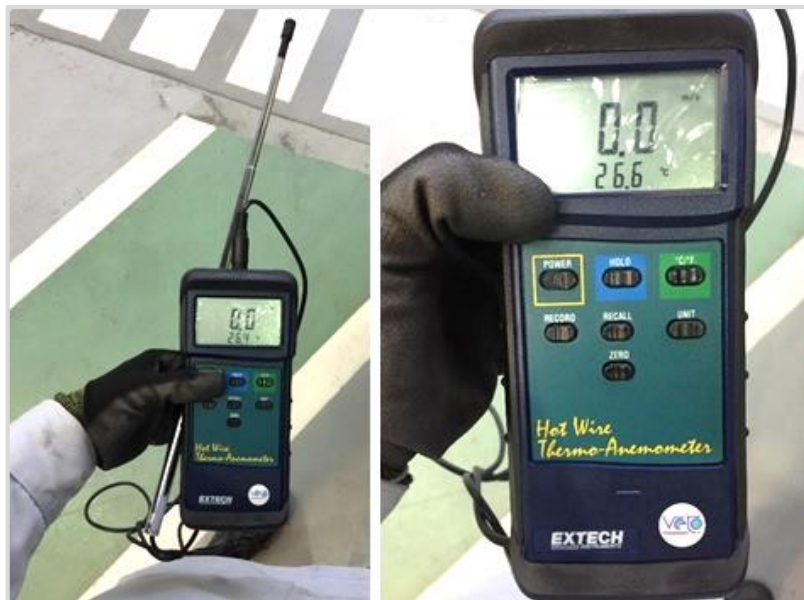
Figura 52 - Anemómetro utilizado para medir la velocidad del aire.
