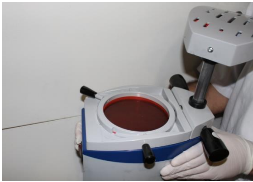
Figura 5: Estampadora PLASTVAC P7 Bio Art con lámina coloreada en posición para el procedimiento de estampado.
