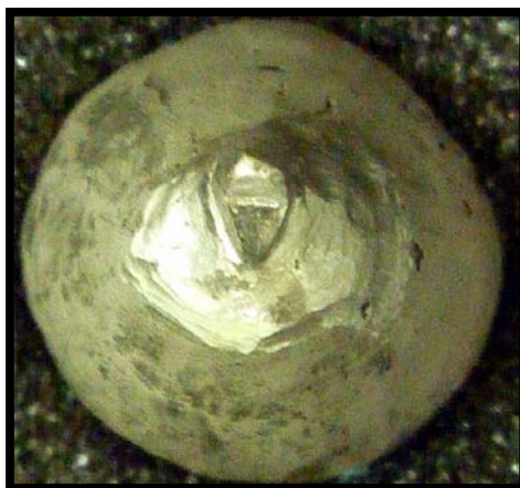
Figura 33: Apoyo de cromo cobalto en la punta de probeta superior, vista superior
