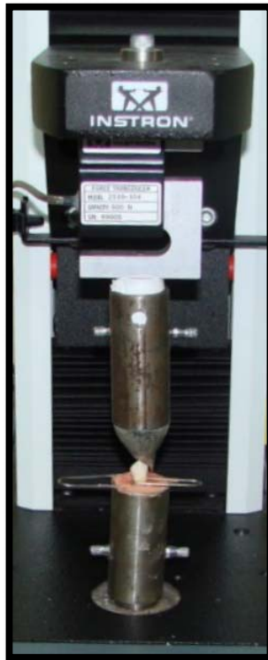
Figura 39: ensayo de compresión en Máquina Instron® serie 3340 en ejecución
