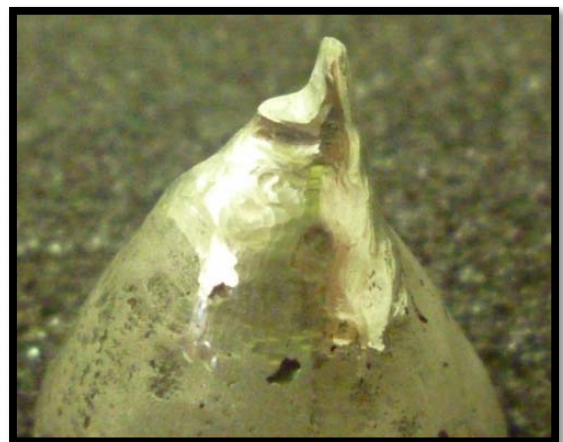
Figura 34: Apoyo de cromo cobalto en la punta de probeta superior, vista lateral
