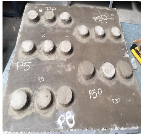
Figura 0.8: Pastelón de hormigón con morteros adheridos
