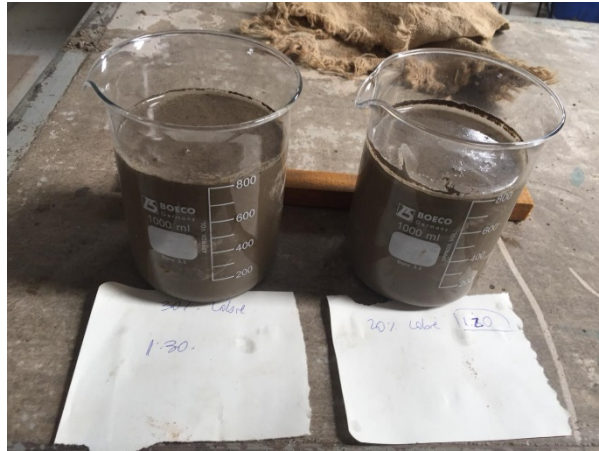
Figura 4.5: Medición del agua de exudación del mortero
