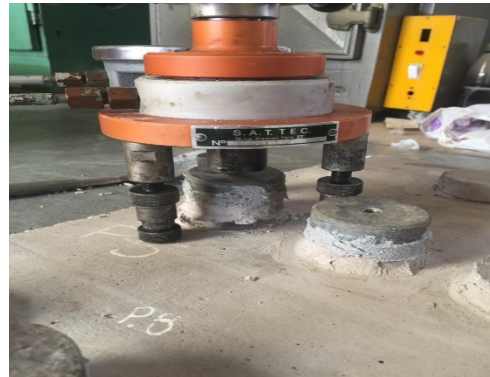
Figura 0.7: Probeta de mortero arrancada del sustrato de hormigón
