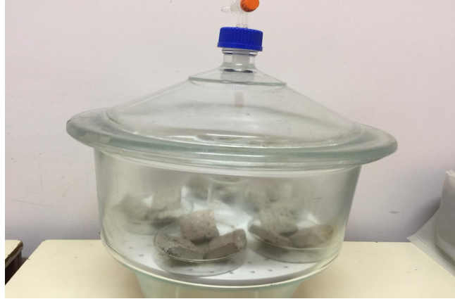
Figura 0.9: Desecadora hermética con probetas de mortero atacadas con CO 2
