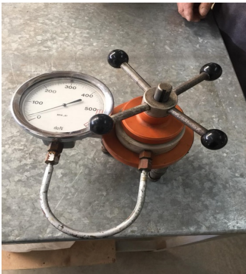
Figura 0.7: Equipo de tracción directa, para adherencia de mortero
