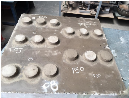
Figura 0.8: Sustrato de hormigón con probetas de adherencia
