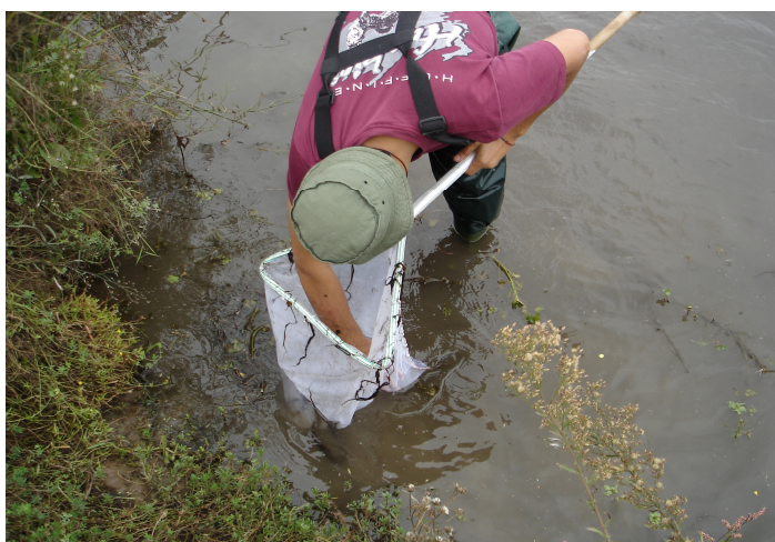
Figura 29: Captura de Macroinvertebrados bentónicos con una red Surber.
