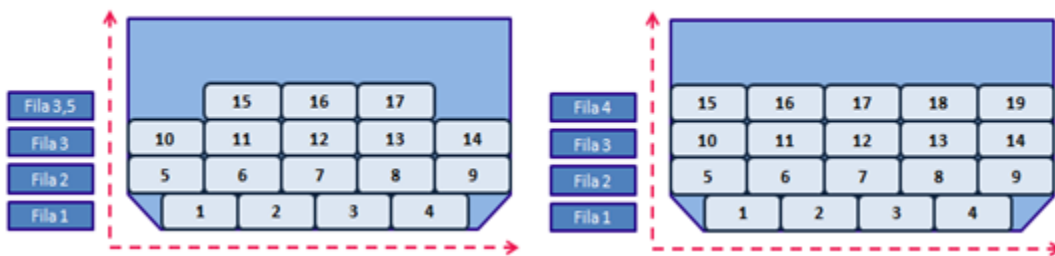
Figura 15. Secuencia de nuevo modelo de carguío de equipaje de bodega en avión. Fuente: Elaboración propia en conjunto con área de Mejora Continua.
