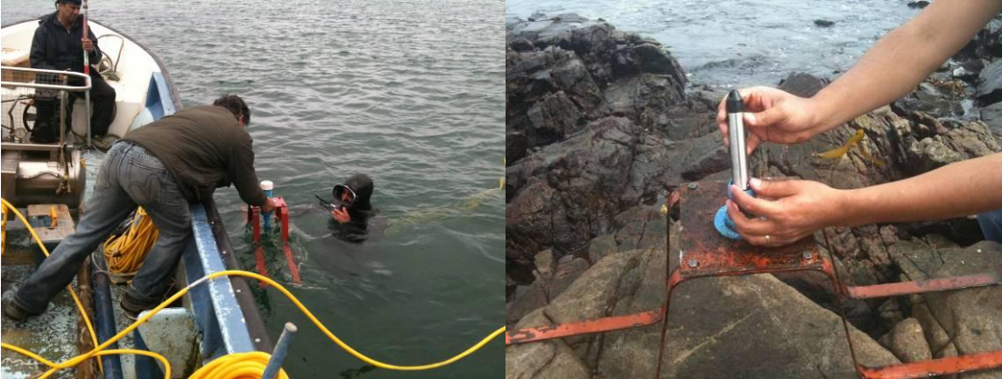
Figura 11: Sistema de fondeo de mareógrafo.
