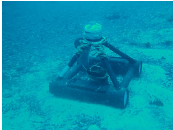
Figura 19: Equipo ADCP fondeado para medir oleaje y corrientes.
