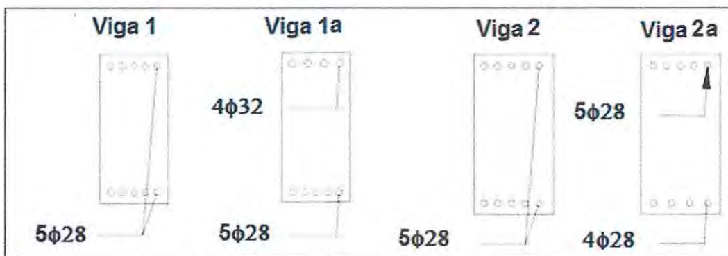
Figura 3.4 Refuerzo Longitudinal Vigas
