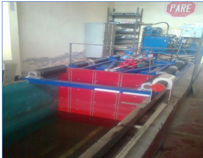
Figura 10: Paleta generadora de oleaje
