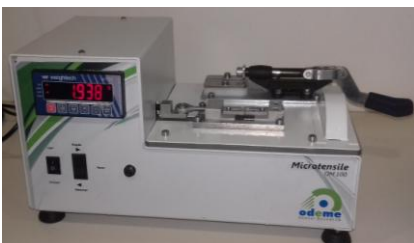
Figura 19. Máquina de microtracción OM 100, registra en su pantalla la fuerza en Kg f (kiloaramos-fuerza).
