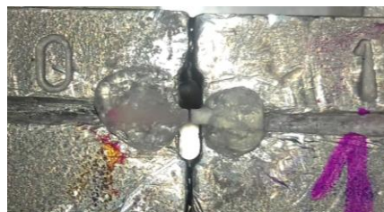
Figura 20. Especimen posterior a test de microtracción.
