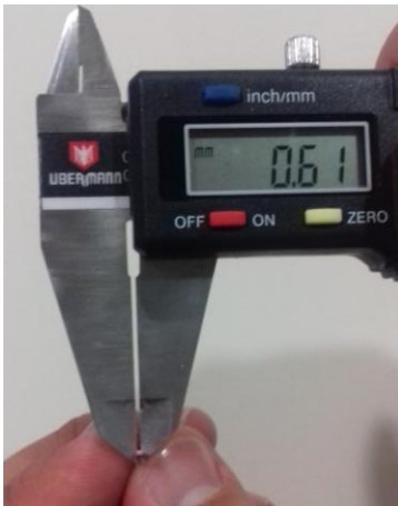
Figura 17. Medición de los lados del espécimen, para obtener área transversal.
