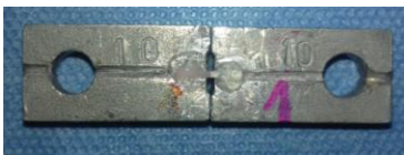
Figura 18. Especimen pegado con gel de cianocrilato en el dispositivo.
