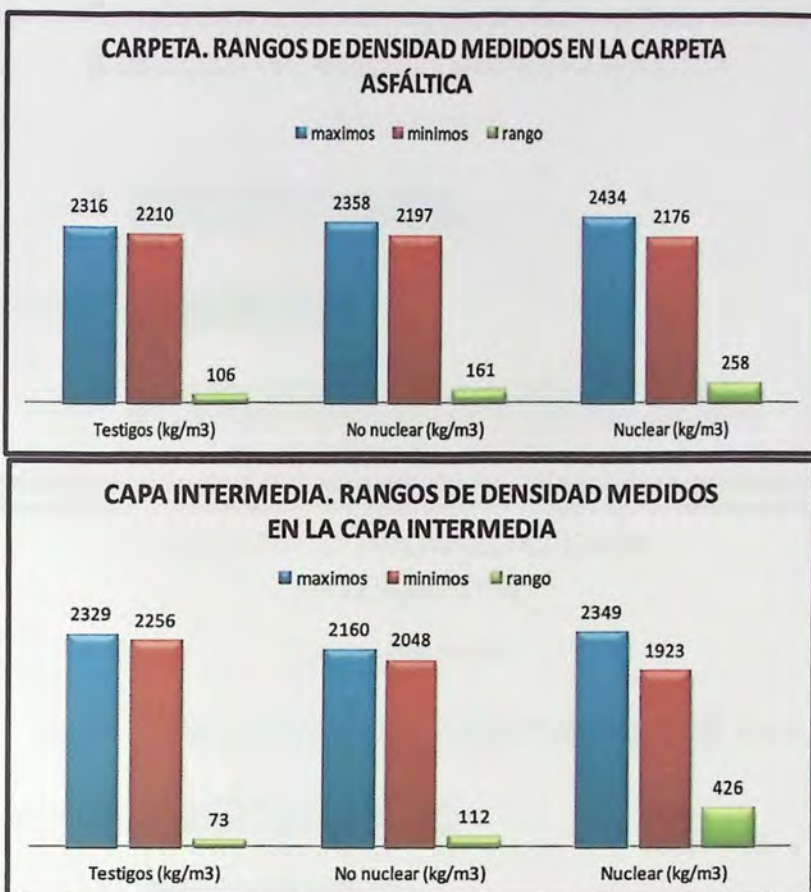
Figura 6.6- Rangos de densidad determinados a la carpeta asfáltica.
