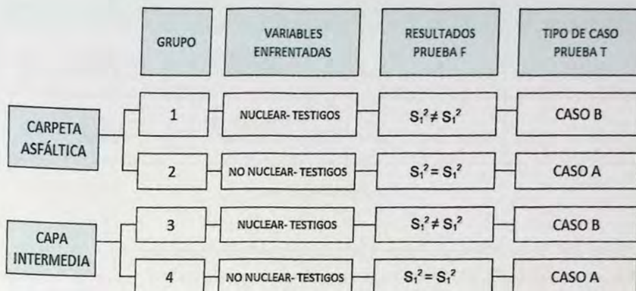
Figura 6.12- Tipo de caso prueba T según resultado de prueba F, para contraste de método de autocontrol-testigos en carpeta asfáltica y capa intermedia.
