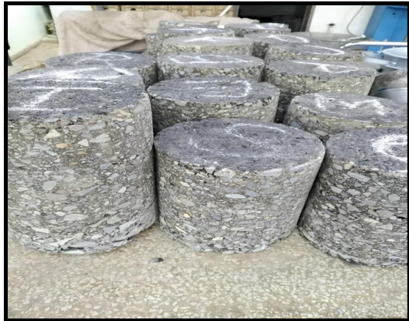
Figura 64 - Testigos de Obra.
