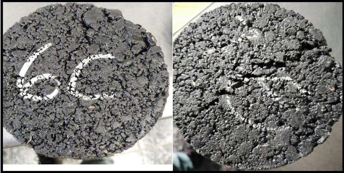
Figura 52 – Probeta ensayada a Tracción Indirecta con y sin FORTA-FI.
