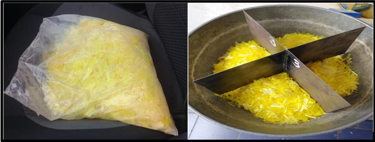
Figura 22 - Caracterización de la Fibra FORTA-FI.
