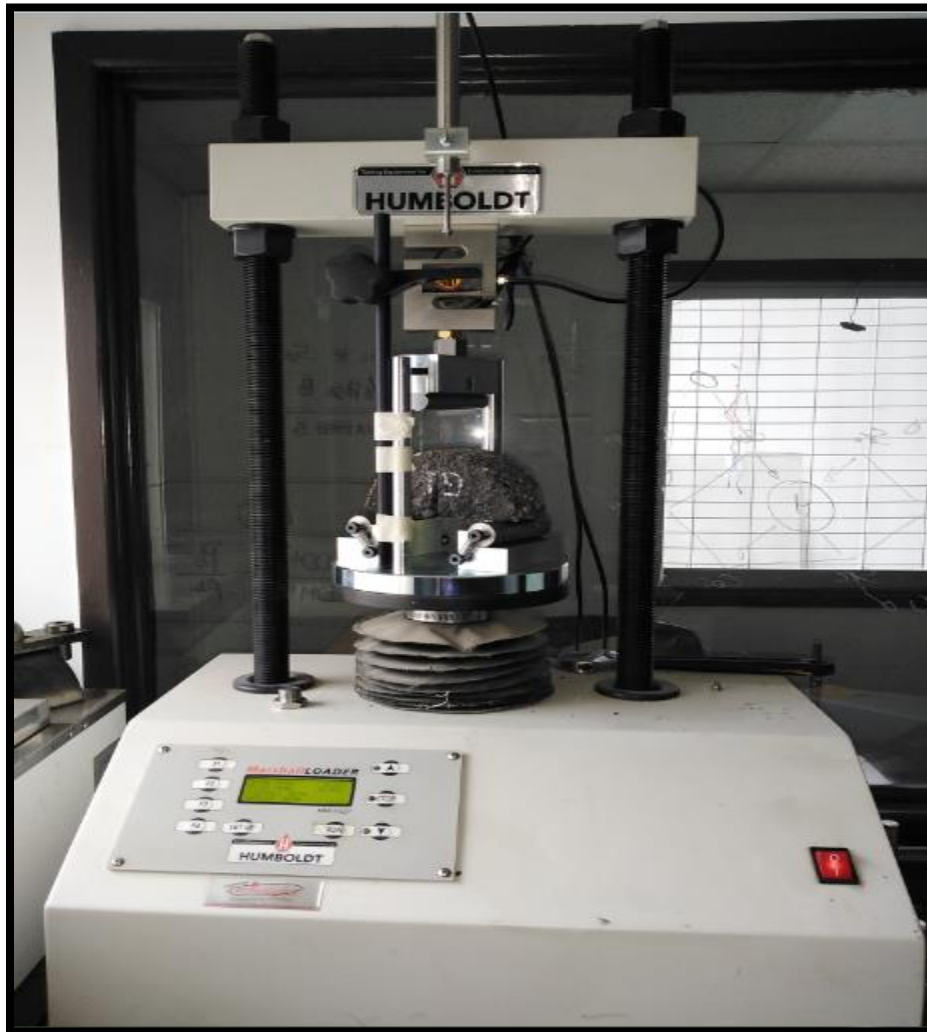
Figura 45 - Ensayo SCB Laboratorio regional de Vialidad.
