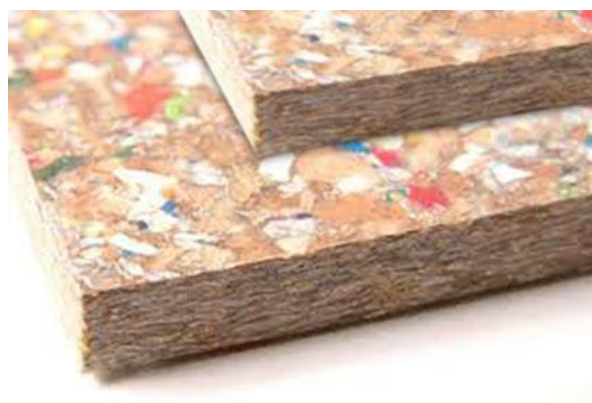
Figura 1-8. Tablero reciclado de envases Tetra pak ®
