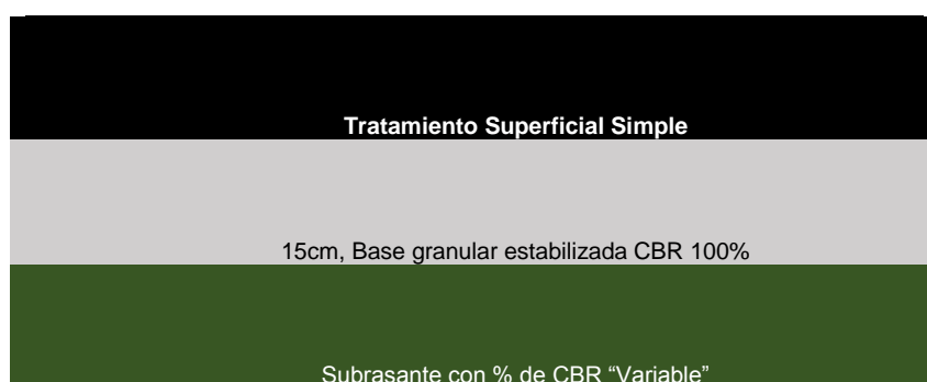
Figura 5.1: Estratigrafía de Tratamiento Superficial Simple (TSS)
