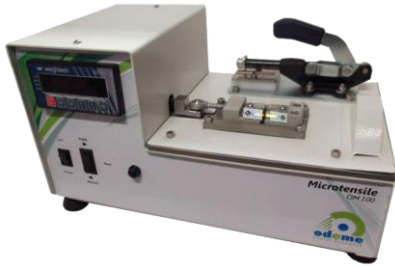
Figura 19. Máquina de microtracción OM 100, registra en su pantalla la fuerza en Kg f (kilogramos-fuerza). Palma J, 2016.
